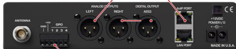
El programa de audio «del aire» a tiempo completo está disponible simultáneamente como I/D-analógico, AES3-digital y Dante/AES67 AoIP streaming, todos con niveles ajustables, además de un flujo IP en Internet de escucha múltiple y una clavija para auriculares en el panel frontal.
