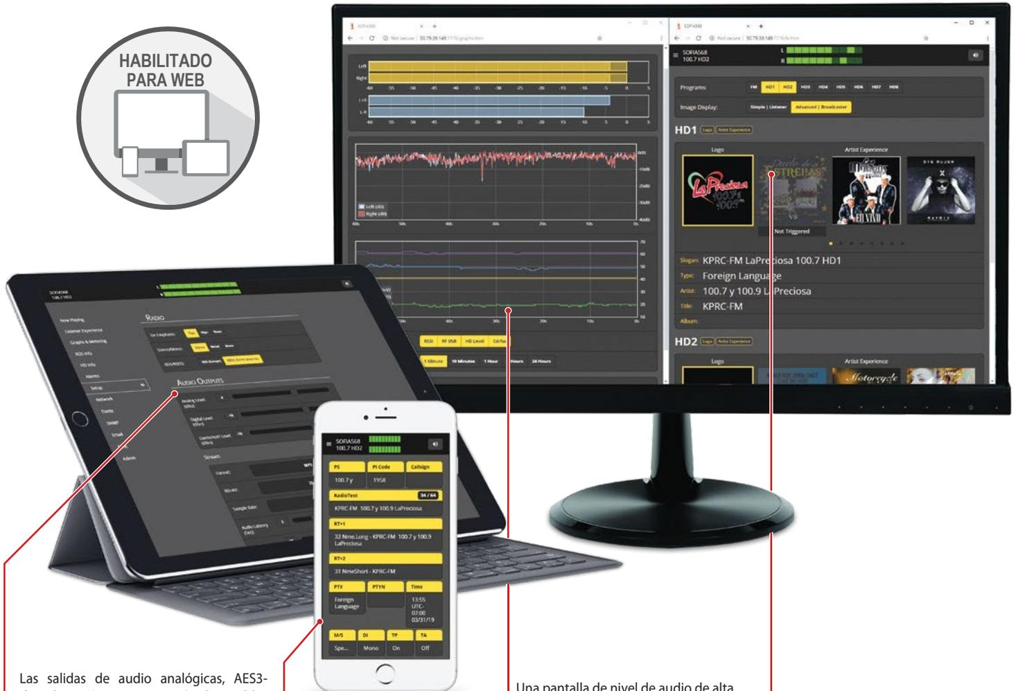
Las salidas de audio analógicas, AES3-digital y AoIP-streaming están disponibles simultáneamente con niveles de audio ajustables independientemente. La utilidad de streaming Web/IP tiene formato seleccionable (MP3/OGG), tasa de bits y velocidad de muestreo, además de latencia de marcación y una configuración de "escuchas máximas" para optimizar el funcionamiento a través de rutas de Internet deficientes.
